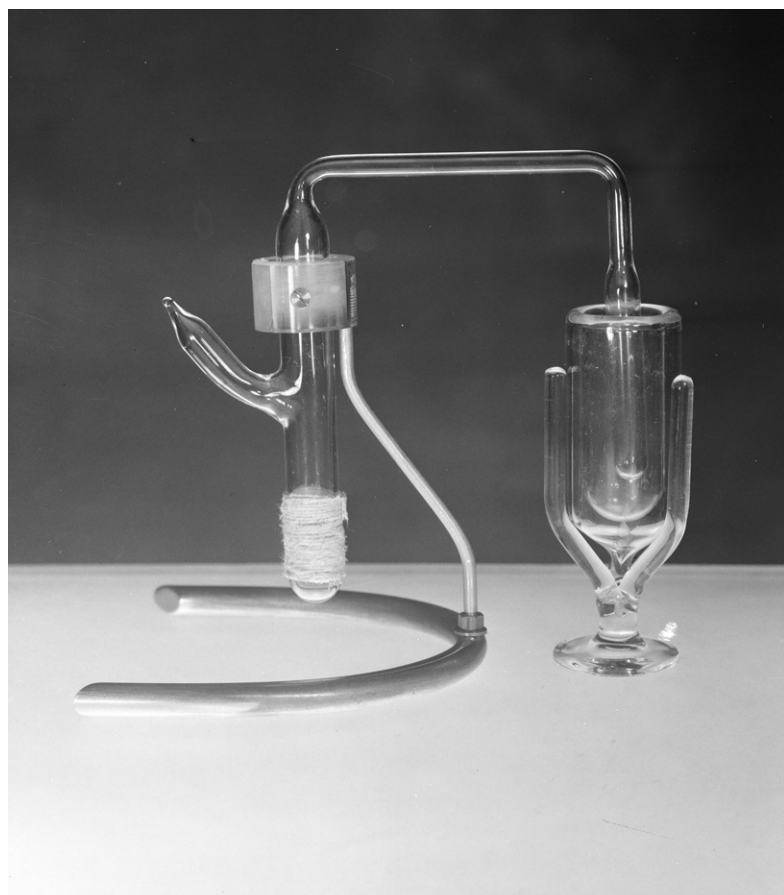
Figure 2. Reproduction du dispositif utilisé par Irène et Frédéric Joliot-Curie pour isoler le radio azote, l'un des premiers radio-isotopes artificiels créés par eux en 1934. Avec l'aimable autorisation du Musée Curie (coll. ACJC). N° de photo MCP1255 (vers 1964)
